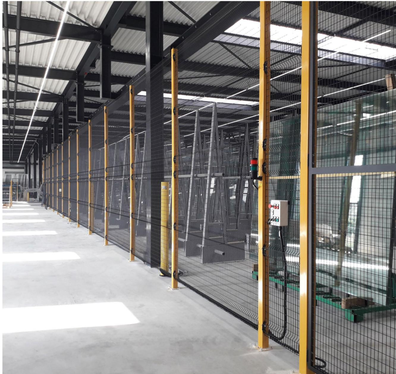
Esempio di applicazione del sistema Techno per la delimitazione di aree con movimentazione di carichi ad altezze elevate.
