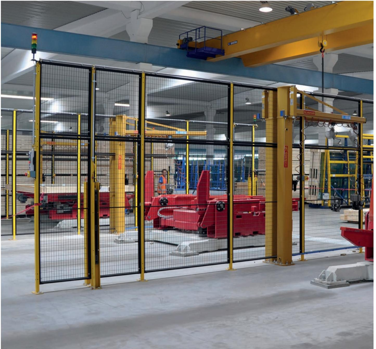
Esempio di applicazione del sistema Novatek per la delimitazione di aree con movimentazione di carichi ad altezze elevate.
