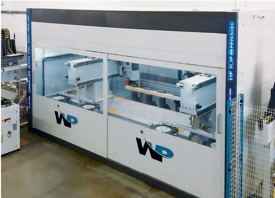
Esempio di applicazione di una protezione stagna contenitiva per i trucioli.
