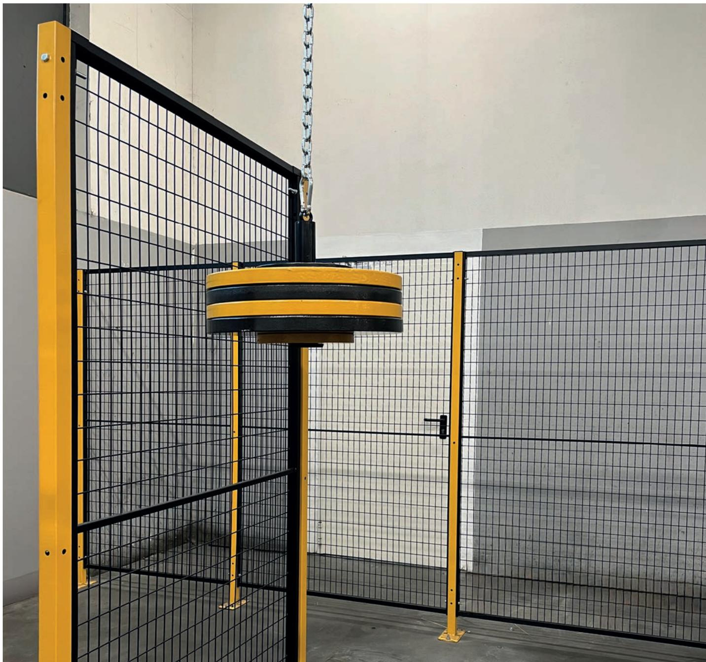
Abbiamo a disposizione un'area di test interna, che ci permette di realizzare test di resistenza dinamica d'impatto dall'interno verso l'esterno utilizzando un corpo rigido.
